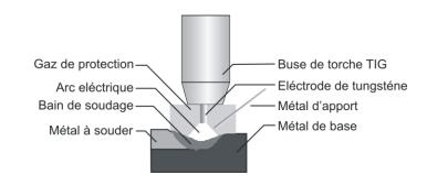
laiton en courant continu (DC) et de l'aluminium en courant alternative (AC). Dans certains cas peut être avantageux en comparaison au soudage MMA (électrode fusible enrobé) ou le soudage MIG surtout sur les travaux avec cordons visibles.
