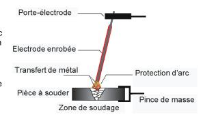
Dans les sources d'alimentation en courant continu (redresseurs) la polarité du courant électrique affecte le transfert de chaleur. Typiquement, l'électrode est reliée au pôle positif (+), bien que dans les soudures des matériaux très minces peut être relié au pôle négatif (-). La position de soudage le plus favorable est horizontale, bien qu'ils peuvent être tenues dans toutes les positions.
