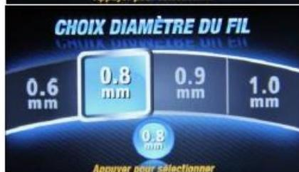
Choisissez le diamètre du fil de soudage monté sur le porte-dévidoir.
