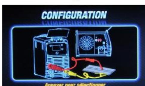
L'écran "SET UP" indique où vous devez connecter la torche MIG et le câble de masse. A l'intérieur, sous le bouton de contrôle du Burn-Back, la plaque doit être connectée avec le "+".
