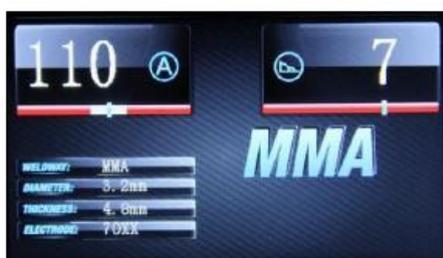
Le libero 200 propose une méthode de soudage en fonction des paramètres de soudage sélectionnés. Ces valeurs peuvent bien entendu être ajustées manuellement.
