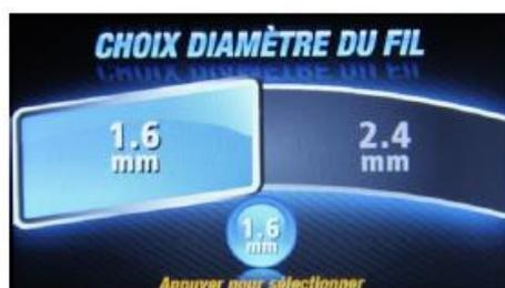
Sélectionnez l'épaisseur d'électrode de tungstène correcte présente dans la torche TIG.
