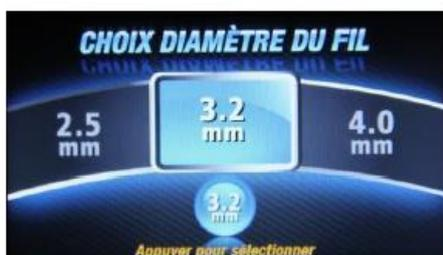
Sélectionnez l'épaisseur correcte d'électrode de soudage 2.5 - 3.2 ou 4.0mm
