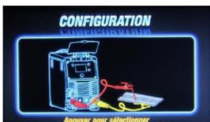
L'écran "MMA SET UP" indique où vous devez connecter le porte-électrode et le câble de terre. Par défaut, l'image à l'écran indique que le câble d'électrode doit être connecté au pôle +, il s'agit du soudage d'électrodes de soudage E70xx.
