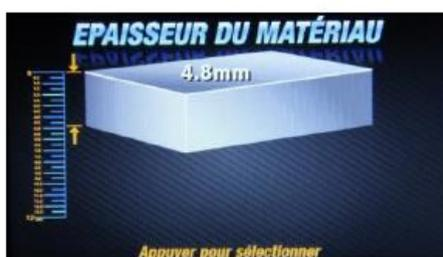
Définissez l'épaisseur souhaitée du matériau à souder. Les réglages minimum et maximum diffèrent en fonction du diamètre de l'électrode de soudage.
