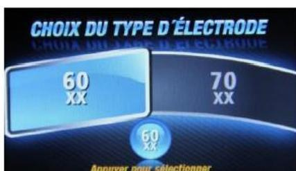
Soudage des électrodes de soudage AWS E60xx.
