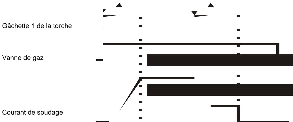
Fig. 5 Déroulement du soudage 4 temps
