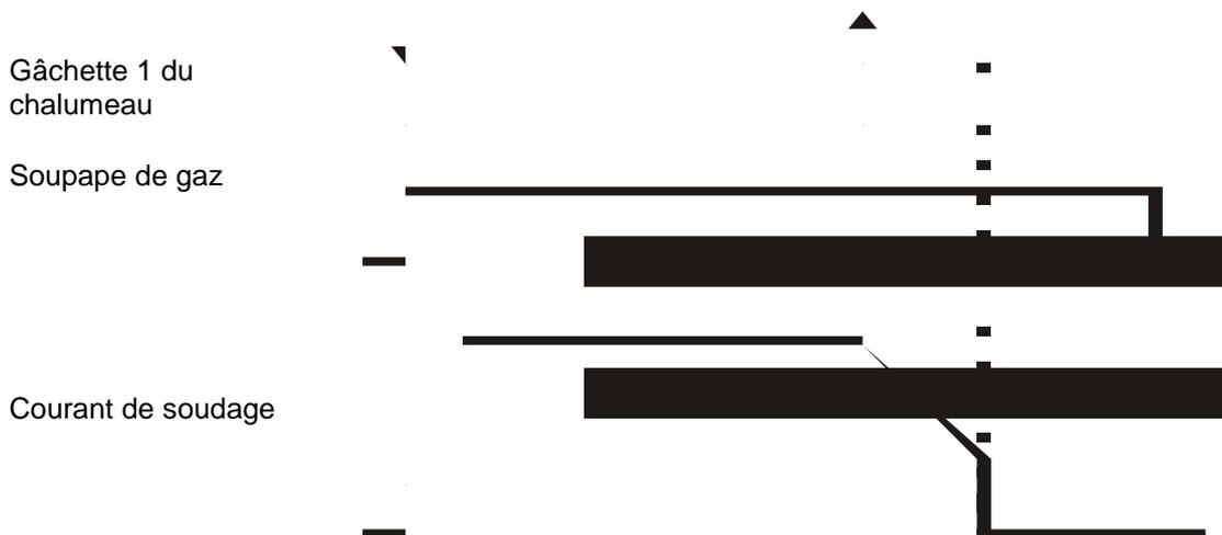
Fig. 6 Déroulement du soudage 2 temps
