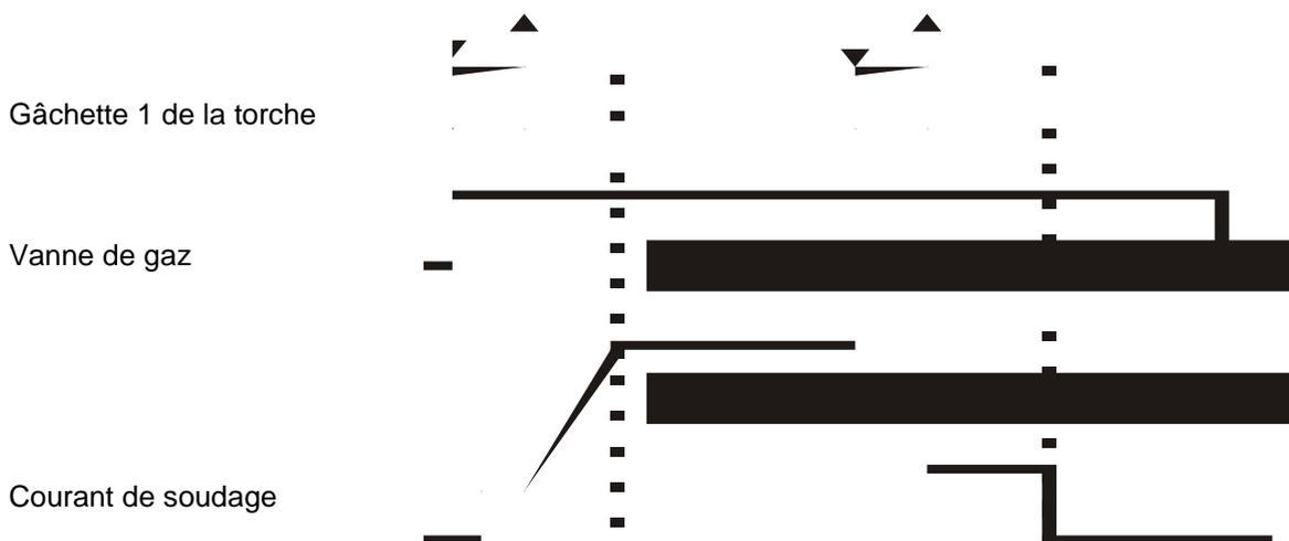
Fig. 5 Déroulement du soudage 4 temps
