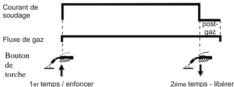
**13 – Mode LED 4T (4 temps)** – Une fois sélectionné, cela indique que la machine est en mode 4 temps. Pour la commodité de celui-ci pour souder de longues soudures, appuyez simplement sur la gâchette de la torche et relâchez-la immédiatement; la machine continue à souder à la gâchette est à nouveau enfoncée (= 3T). Pour arrêter, appuyez à nouveau sur la gâchette de la torche (= 3T) et laissez le déclenchement de la torche au bon moment (= 4T).
